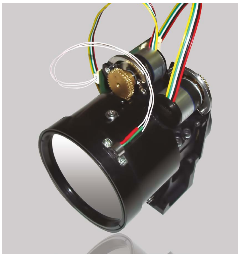
↑ Вариофокальный ИК-объектив с фокусным расстоянием 15–60 мм
