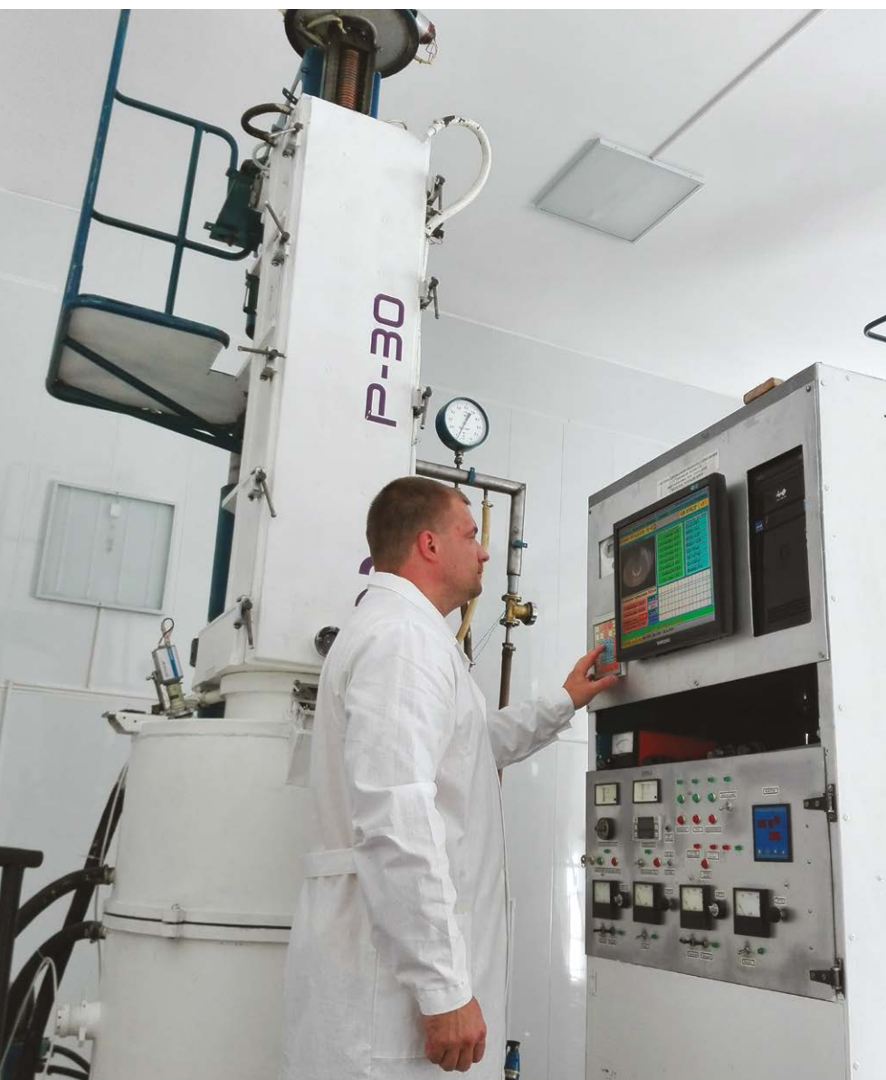
↑ Выращивание монокристаллов оптического германия
