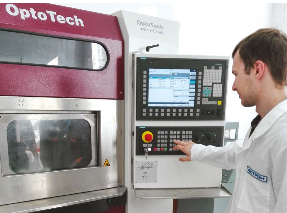
↑ Шлифовка оптических линз на высокоточном роботизированном станке
