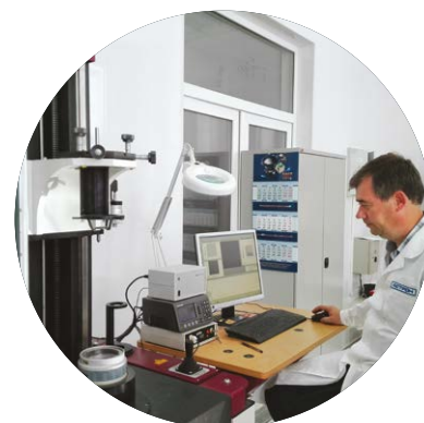
↑ Проверка точности обработки оптических деталей на прецизионном интерферометре
