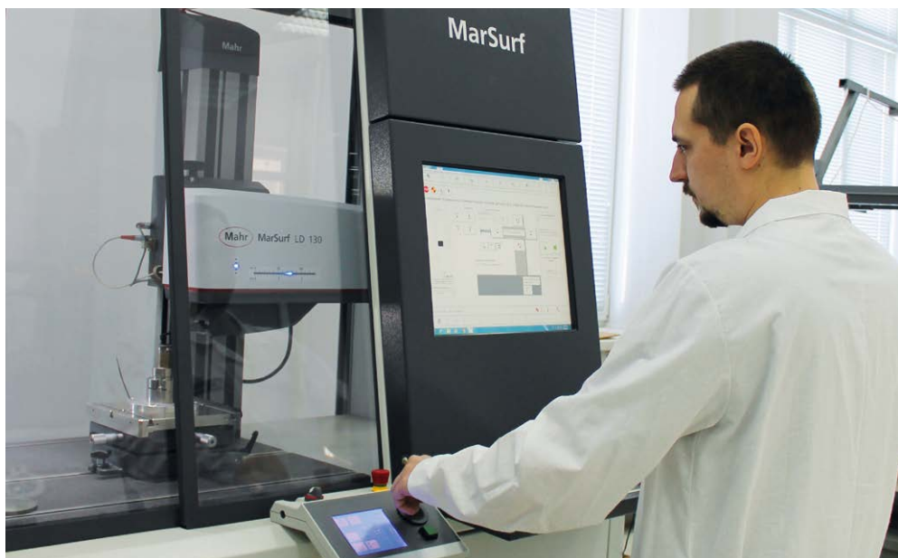
↑ Оценка качества поверхности покрытия и микрогеометрии оптической детали на профилографе
