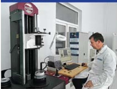
Интерферометр для прецизионных измерений оптических деталей
