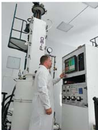
Установка для выращивания монокристаллов оптического германия
