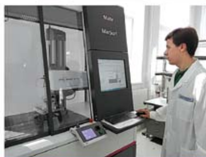
Профилограф для оценки качества поверхности покрытия и изучения ее микрогеометрии
