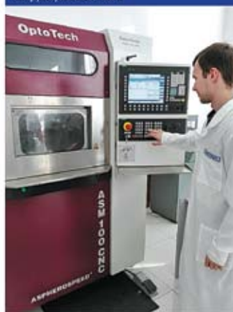
Станок для шлифовки оптических инфракрасных линз
