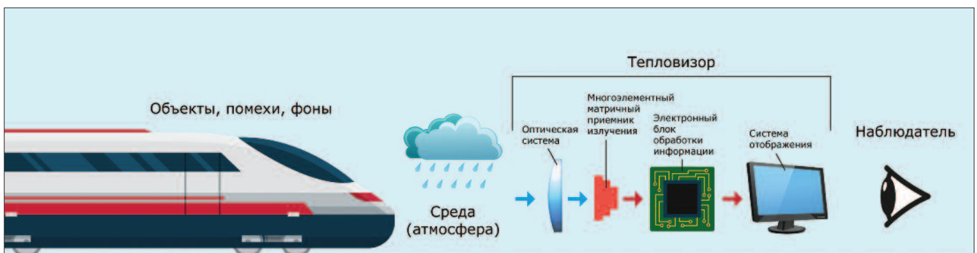
Рис. 1. Схема работы тепловизора
